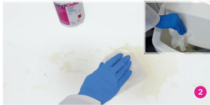
Mit sauberem Papiertuch abwischen, um Verschmutzungen und Keime zu entfernen. Wischtuch nach Gebrauch entsorgen.
